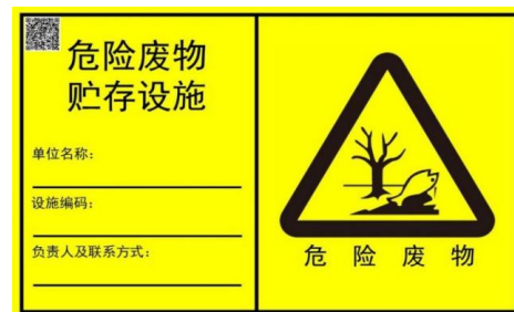
危险废物间标志
