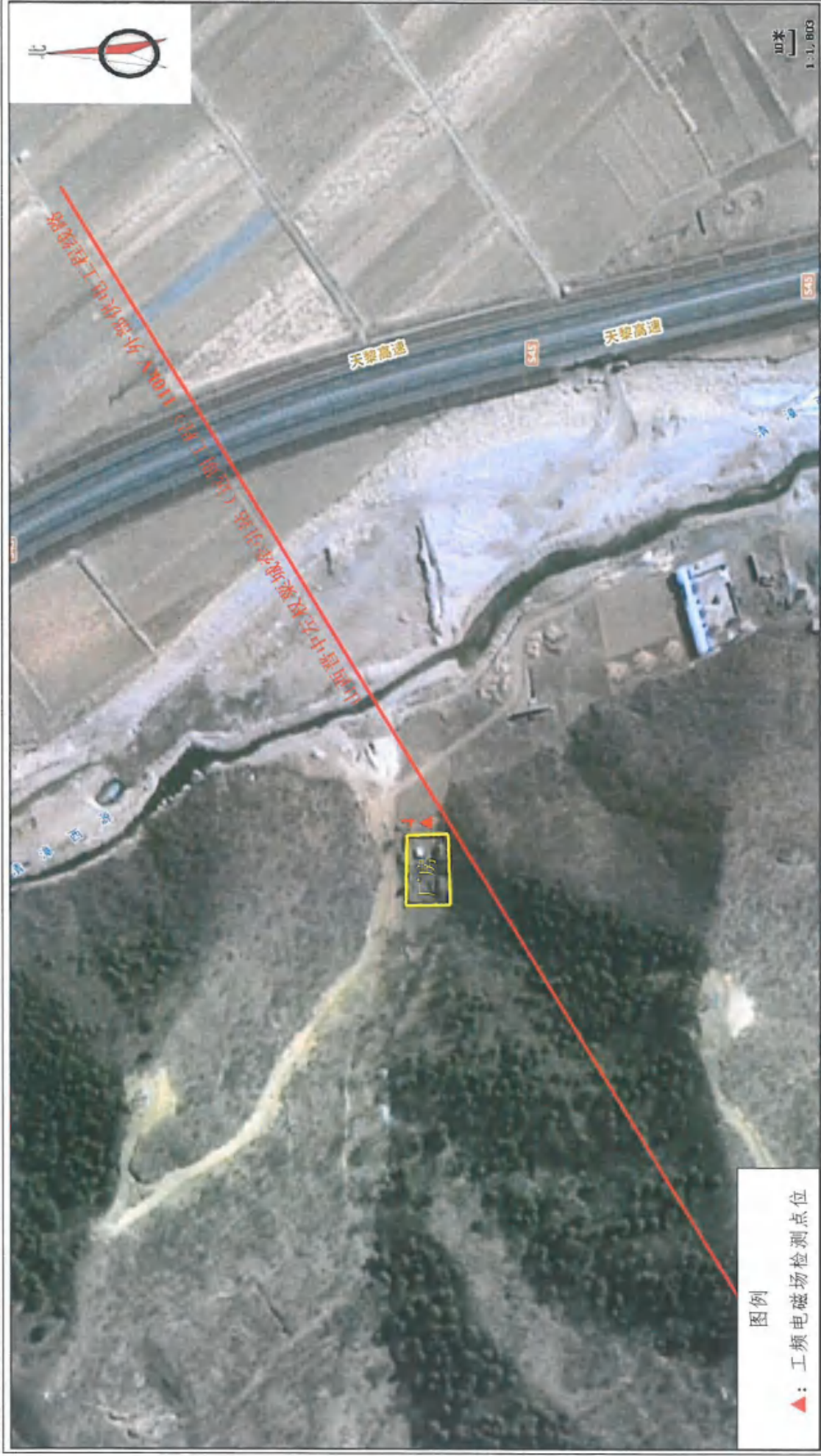
图2 山西晋中左权栗城牵引站(远期工程)110kV外部供电工程工频电磁场检测点布置示意图
