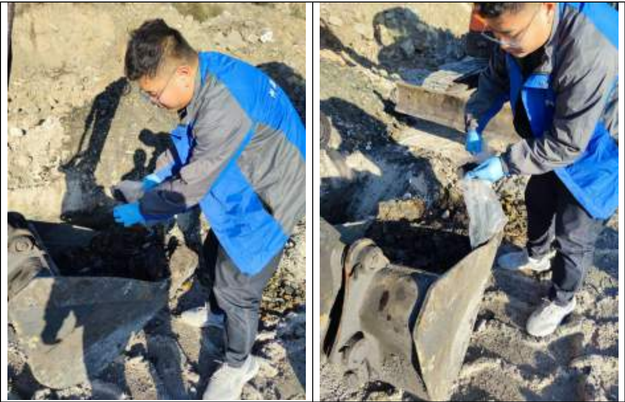
柱状样（污水站北侧空地）100cm 以下为煤矸石
