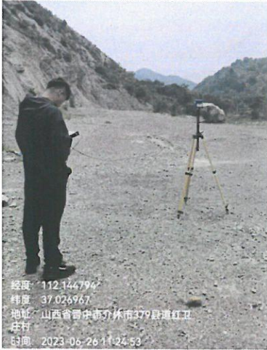
拟建升压站站址电磁场监测
